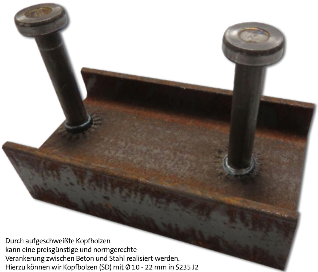
Durch aufgeschweißte Kopfbolzen kann eine preisgünstige und normgerechte Verankerung zwischen Beton und Stahl realisiert werden. Hierzu können wir Kopfbolzen (SD) mit  $\varnothing$  10 - 22 mm in S235 J2 und  $\varnothing$  10 - 16 mm in rostfreiem Material schweißen. Die Länge der Kopfbolzen kann zwischen 50 und 525 mm variiert werden. Als Schweißverfahren kommt ein Hubzündungs-Bolzenschweißen mit Keramikring nach DIN EN ISO 14555 zum Einsatz.
